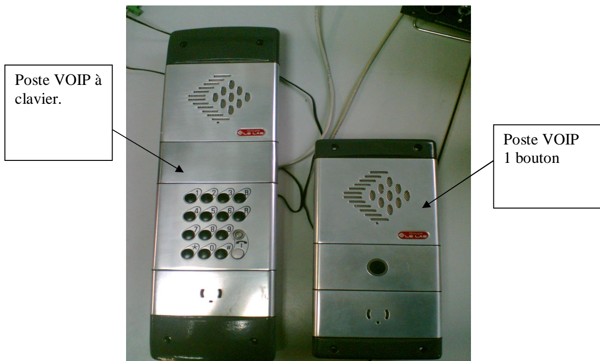
Photo2 : Branchement postes VOIP sur le réseau local Ethernet
